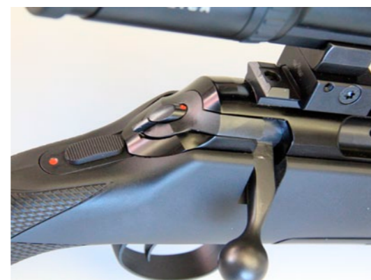
Die Titan Alpha verwendet ein klassisches System mit Zylinderverschluss und Zweistellungssicherung am Kolbenhals.
