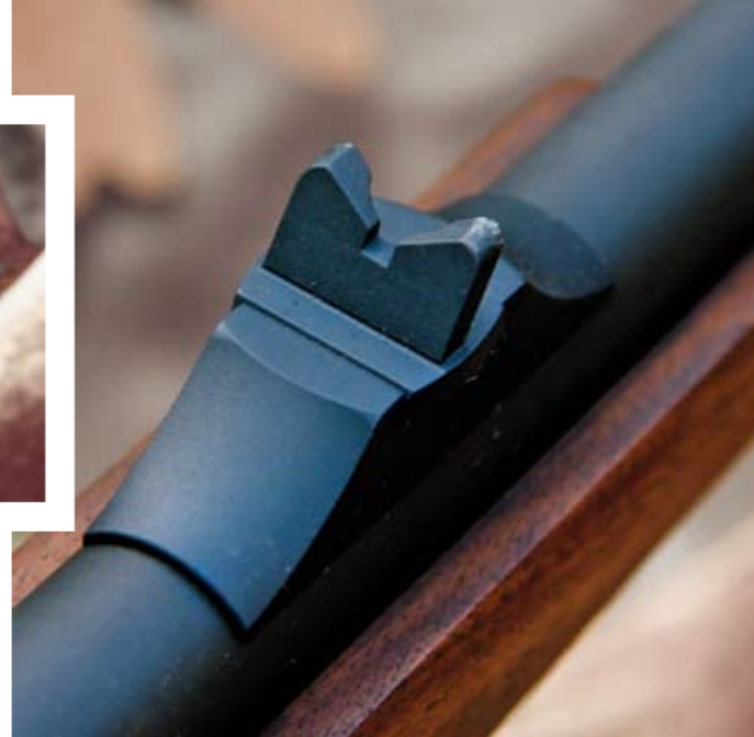
O cano vem equipado com miras convencionais; alça em “U” regulável em deriva e ponte de mira que permite afinação em altura.
