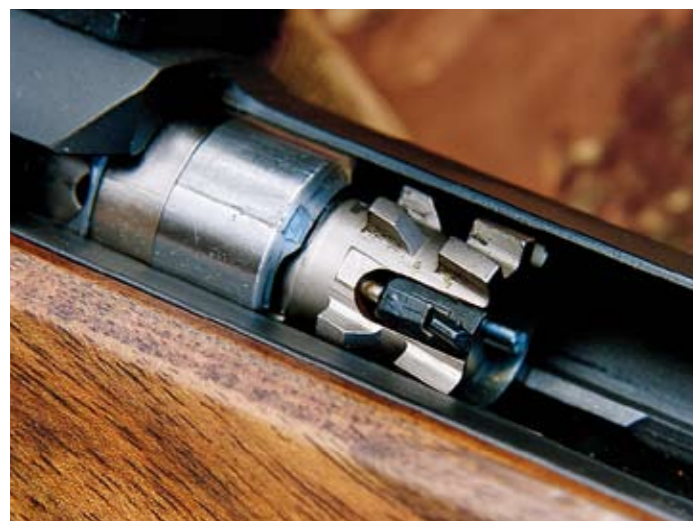
A cabeça da culatra é rotativa. Note-se o conjunto de trincos que garantem a obturação da câmara.
