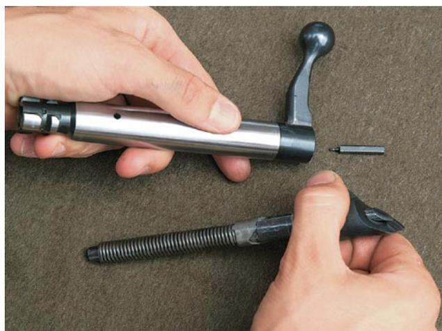
**Durch Lösen von vier Schrauben mit einem Imbusschlüssel lässt sich der Titan 6-Repetierer vollständig zerlegen.**
