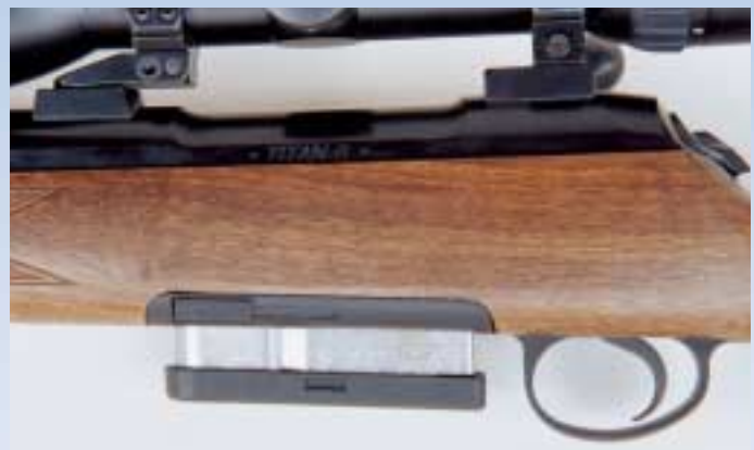
Nach dem Drücken der beidseitigen Entriegelungsleisten springt das Magazin ein wenig heraus und kann gut entnommen werden.
