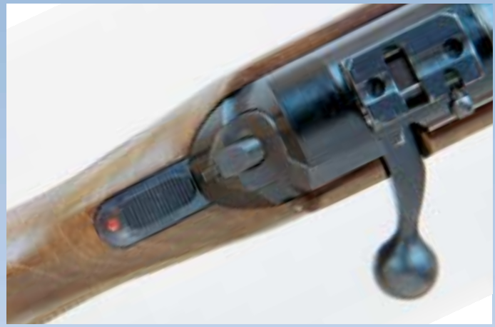
Schiebesicherung und Anzeige des Schlosszustands am Schlässchen.
