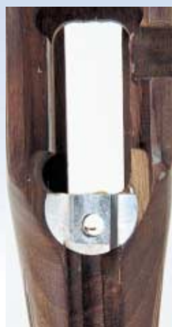
Der Hülsenschwanz liegt auf einer Aluminium-Platte.
