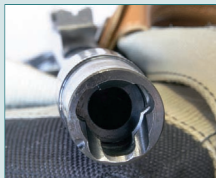
Zadní čelo hlavně s drážkami pro uzamkyací ozuby
