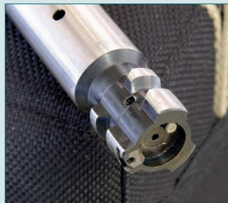
Uzamkyací ozuby na čele závěru
