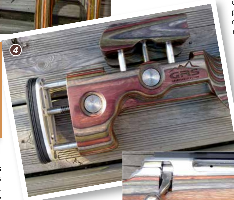
3 - C'est la partie rectangulaire du manchon qui sert de tenon anti recul, venant s'insérer dans un bedding plastique qui mériterait un encollage plus régulier. 4 - La crosse GRS est très agréable et facile à régler avec les deux gros boutons qui commandent le busc ou la plaque de couche. 5 - Le chargeur contient 4 cartouches dans tous les calibres mentionnés sur son côté gauche. Il faudra changer de chargeur en adoptant des calibres plus réduits en diamètre.
