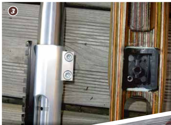
3 - C'est la partie rectangulaire du manchon qui sert de tenon anti recul, venant s'insérer dans un bedding plastique qui mériterait un encollage plus régulier. 4 - La crosse GRS est très agréable et facile à régler avec les deux gros boutons qui commandent le busc ou la plaque de couche. 5 - Le chargeur contient 4 cartouches dans tous les calibres mentionnés sur son côté gauche. Il faudra changer de chargeur en adoptant des calibres plus réduits en diamètre.
