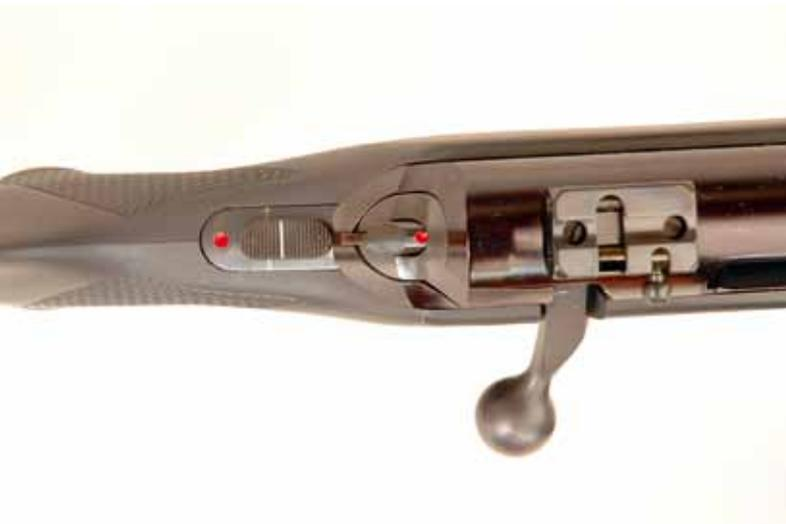
Austritt der Schlagbolzenmutter aus dem Schösschen und Schiebesicherung auf dem Hülsenschwanz.
