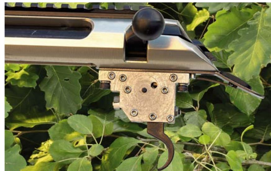
**Der Flintenabzug mit eingestelltem Abzugsgewicht von 900 Gramm und seinen beiden Justierschrauben.**
