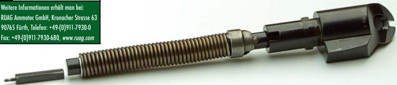
**Herausgenommenes Schloss mit doppelter Zündeinheit (Schlagstück und -bolzen) und starker Antriebsfeder. Die doppelte Spannkurve im Detail.**
