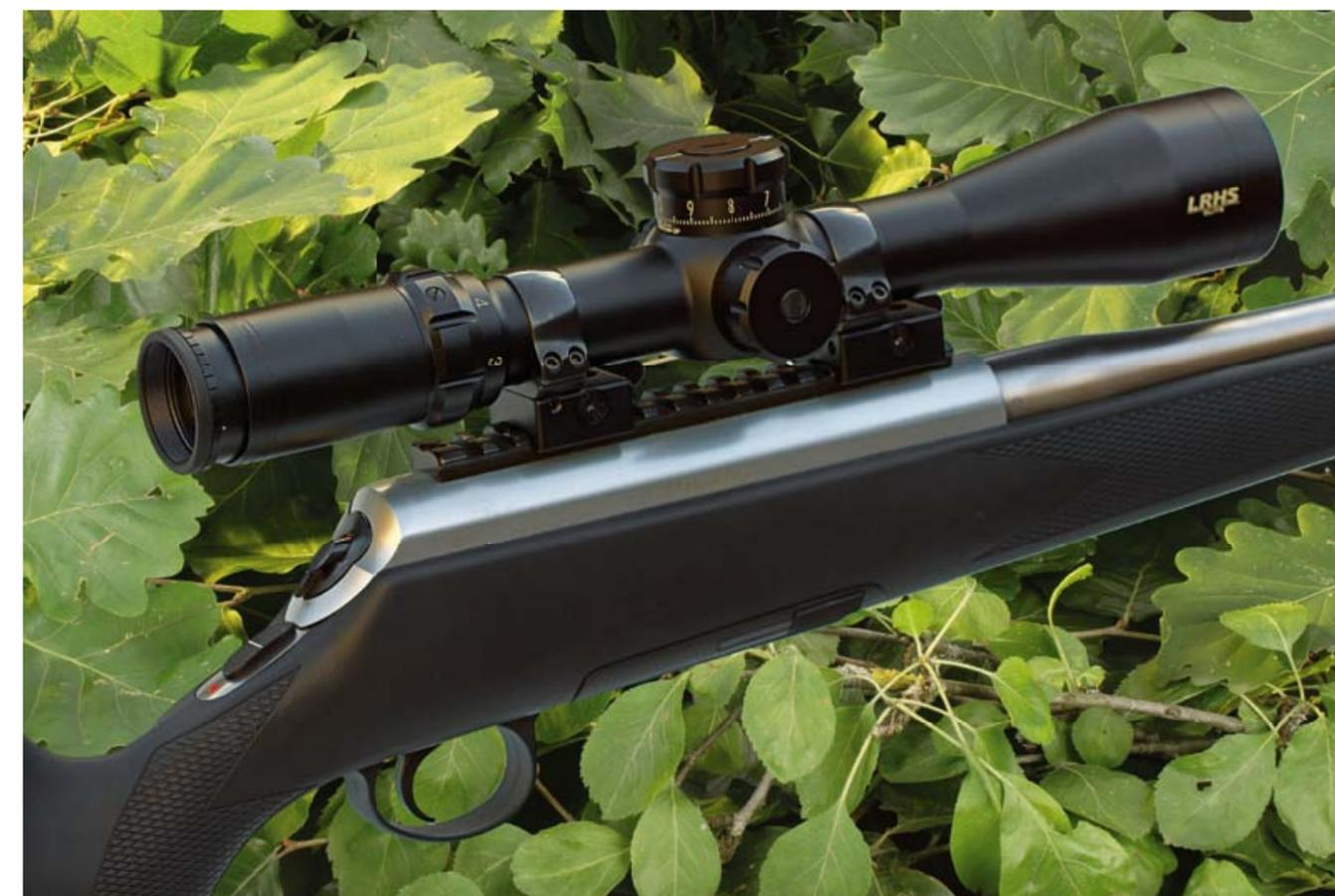
Montiert wurde eine Picatinny-Schiene, EAW 365 Aufklippmontage und Bushnell 3-12x44 LRHS-Zielfernrohr.
