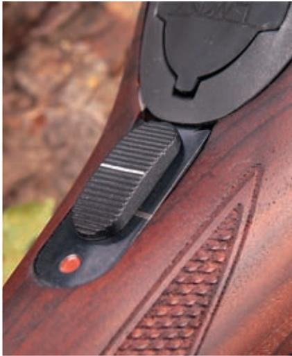
**Die Dreistellungs-Sicherung auf dem Kolbenhals arbeitet nahezu lautlos.**
