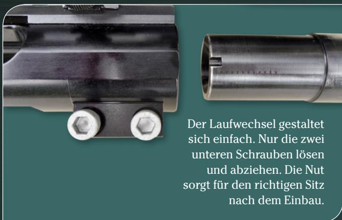
Der Laufwechsel gestaltet sich einfach. Nur die zwei unteren Schrauben lösen und abziehen. Die Nut sorgt für den richtigen Sitz nach dem Einbau.
