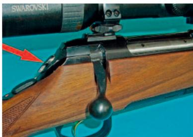
*Der Schlagbolzen ist massiv und kann in gespanntem Abzug gut gesehen und gefühlt werden.*
