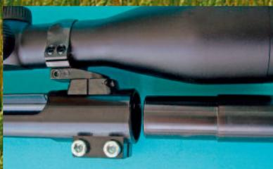
*Nach dem Lösen der beiden Inbuschrauben kann der Lauf leicht nach vorne herausgezogen werden.*
