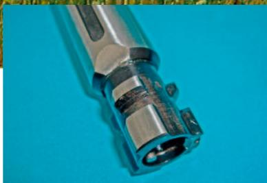
*Verschlusskopf mit den 6 massiven Verriegelungswarzen, welche in die Nuten im Lauf eingreifen.*
