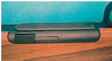
*Eingesetztes Magazin. Zum Herausnehmen sind die beidseitigen Tasten zu drücken.*
